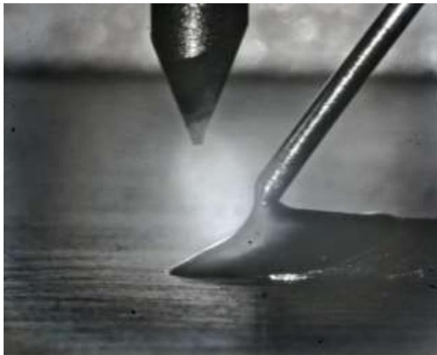
電子ビーム、アークなどでワイヤを溶かし基板上に堆積させる方式
