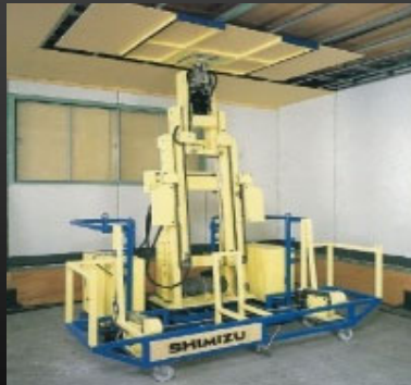
'89 天井ボード張ロボット
