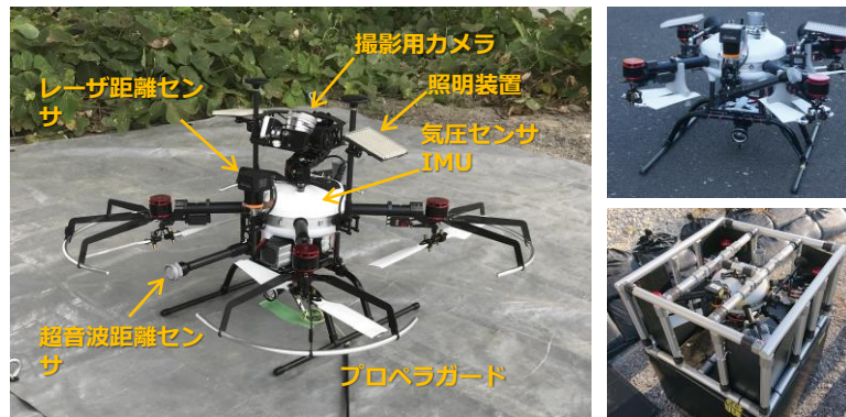
安価なセンサを搭載した小型化可能なマルチコプタ (運搬時サイズ：500×500×400mm)
