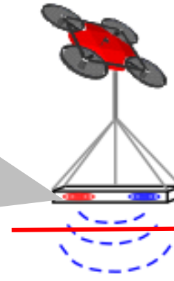
電磁探査装置GEM2
