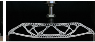
細い部材で局所座屈が連続的に生じることで冗長性が増し、全体として高い座屈性能を発現した
